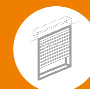
Geïntegreerd rolluik in de spouwmuur
